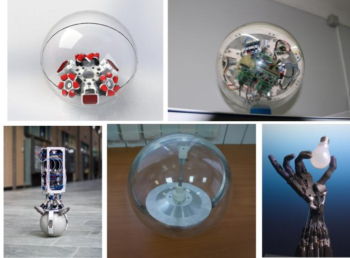
Рис. 4: Натурные модели сферического робота и руки робота-манипулятора
