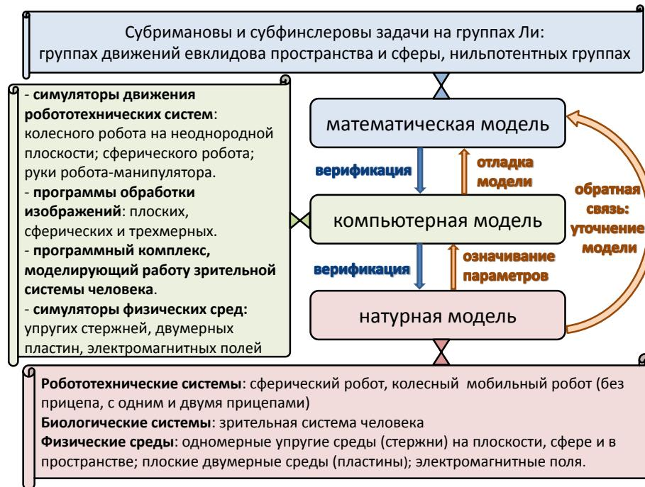
Рис. 1: Сквозное моделирование предполагает проведение исследований на нескольких взаимосвязанных уровнях: математическое, компьютерное и натурное моделирование.
