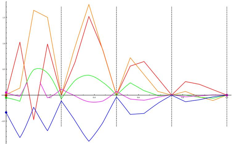
Рис. 1. Траектории системы «шар на плоскости» (в отклонениях)
