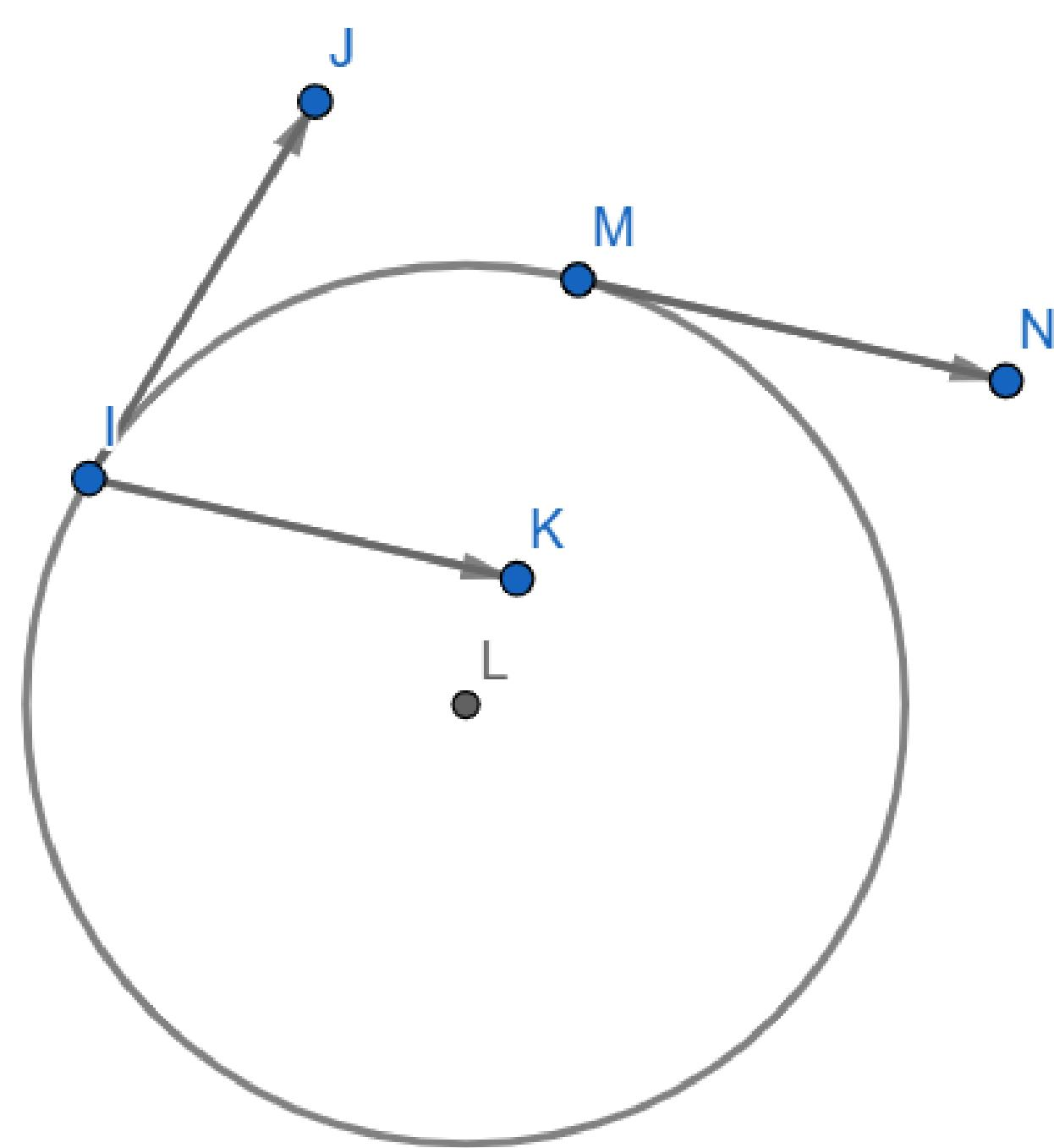
Если  $IJ$  - начальное положение, а  $MN$  - конечное, то движемся по окружности направо до положения  $MN$  - когда вектор станет параллелен конечному.
